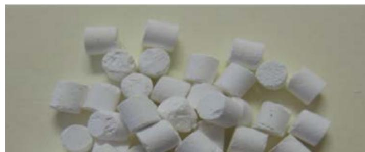
**Figura 1.** Aspecto de los monolitos calcinados de cenizas volantes.
