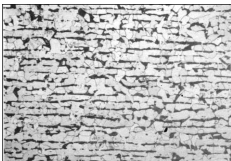
Figura 10: Microestructura del Acero ASTM A36 en estado de suministro; ferrita y perlita fina forma del grano alargada en el sentido de la laminación. 100X. Ataque químico con nital al 2%.
