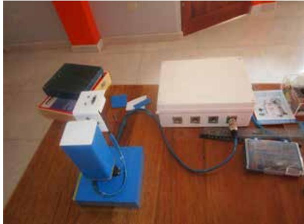
**Figura 1.** Equipo seguidor de sol
