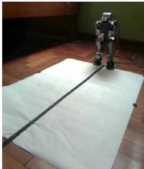
**Figura 2.** Mecatrón en desplazamiento sobre la trayectoria recta (pista 1).
