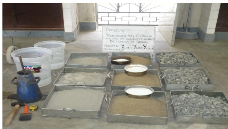
FIGURA N° 01 Materiales constituyentes de las mezclas
